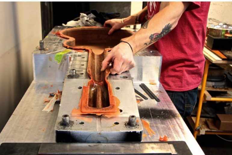
Процесс изготовления цельного композитного корпуса гитары фирмы Blackbird
