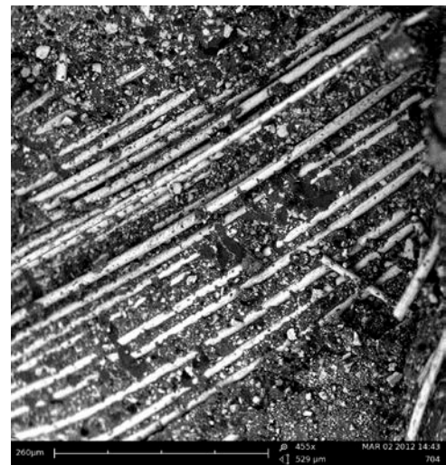
Рис. 3. Структура образцов из ПКМ на основе полиэфирной смолы, армированной рубленым стекловолокном, в поперечном (а-в) и продольном (г-е) направлениях после разрушения при испытаниях на растяжение
